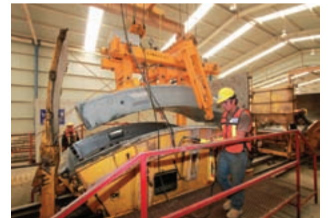
Lista una dovela, con peso de 5 toneladas
